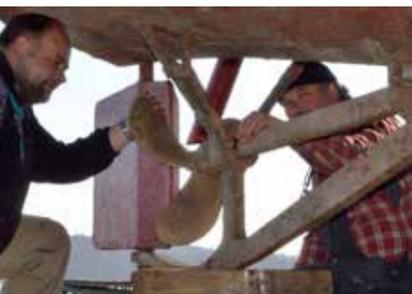
Die Bootsführer Oliver Welbers und Michael Link kontrollieren den Zustand der Schiffsschraube unter dem Heck der MS Luise und prüfen die Oberfläche des stählernen Bootsrumpfes.
